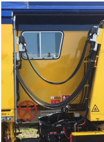
図VII-3.1 車両に取り付けられたHan® HPRジャンパーシステムとストレインリリーフ
