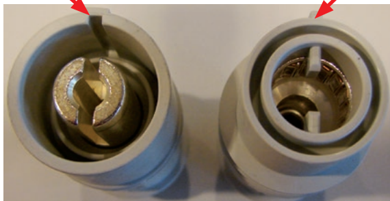
図V-8.1 Han® HC Modularコンタクトのコーディングペグとコーディング溝
