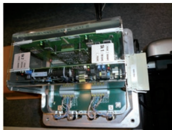
図II-8.2 車軸計数装置とDINプラスチックハウジングの細部
