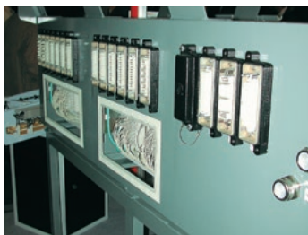
図II-10.4 補助電源装置背面部での Han®コネクタの使用例
