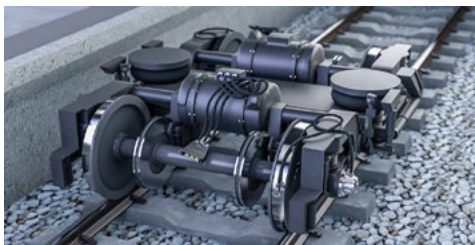
図VII-8.4 鉄道車両のボギーケーブルアセンブリ (床下)
