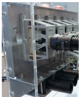
図II-4.4 改造ハウジング付き IP20車両間接続
