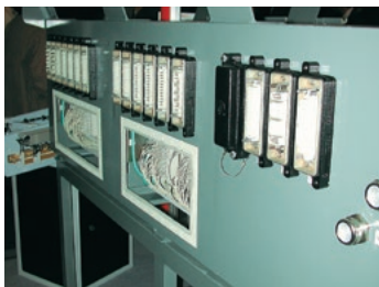
図II-10.4 補助電源装置背面部での Han®コネクタの使用例
