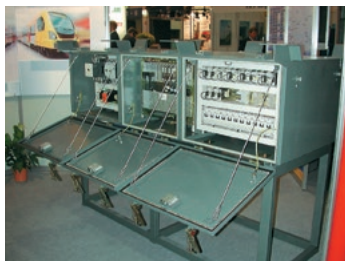
図II-10.3 補助電源の外観
