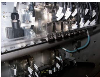
図II-14.2 ブレーキ制御ユニット (於:InnoTrans展示会)
