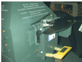
図II-12.3 型式Fb 218サードレール方式パンタ グラフの外観
