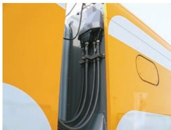
図II-4.2 車両間接続用コネクタ
