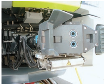
図II-13.1 連結ユニットと車両間の Han® HPRインターフェース
