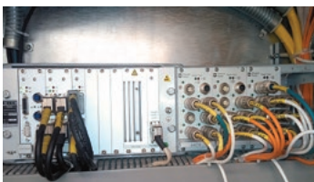
図II-7.2 イーサネットを用いた列車制御ユニット
