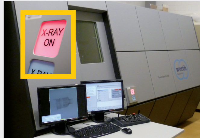
Computertomograph; 3D Darstellung und Analyse
