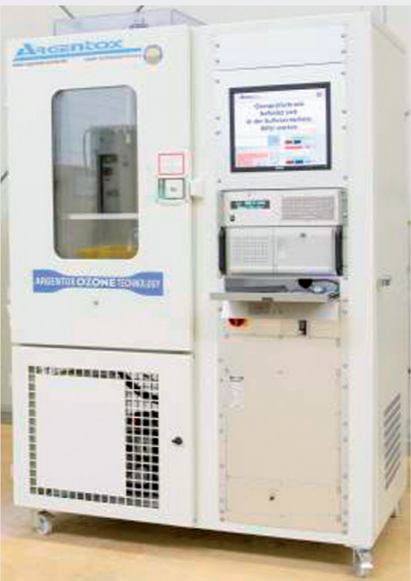
Ozon-Prüfschrank: Einsatz in der Materialalterung und -prüfung
