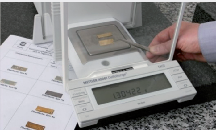
Wägung galvanisch beschichteter Prüfplättchen vor und nach dem Mehrkomponenten-Industriegastest
